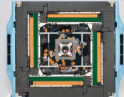
大型ドラムターンテーブルで牌を搅拌し、4力所から牌を拾い上げる構造により、牌の偏りを大幅に軽減します。
